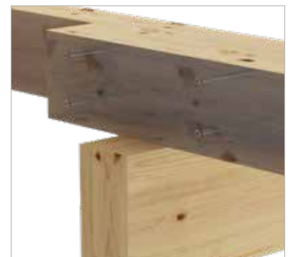
Connexion de deux poutres qui se croisent
