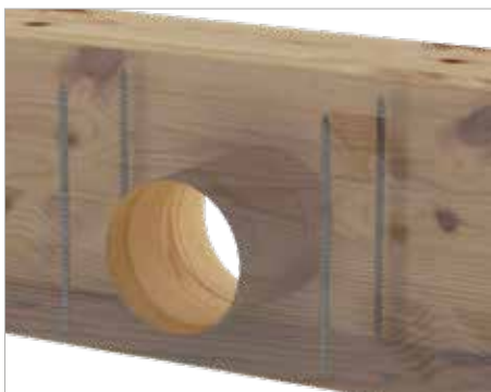
Renforcement à l'endroit fragilisé par l'existence d'un trou
