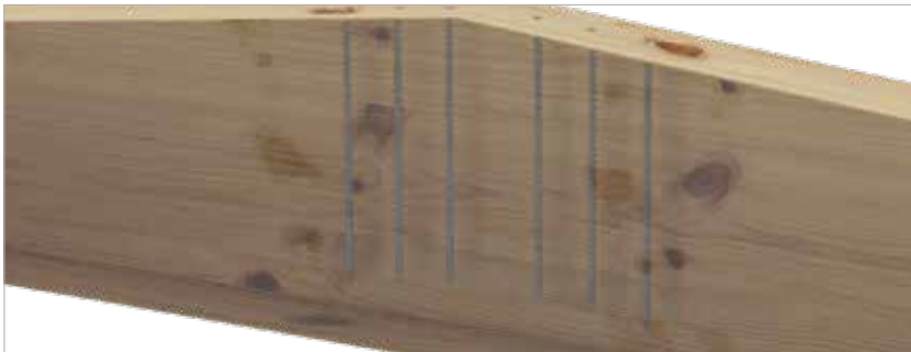
Renforcement avec des vis dans la zone de façade
