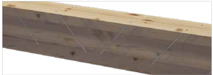
Renforcement par ajout d'une deuxième poutre
