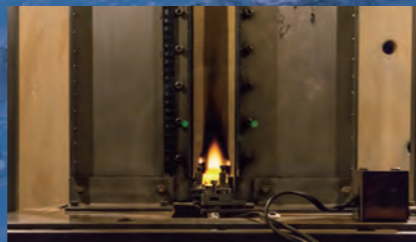
NASA基準による材料可燃性評価試験の様子
