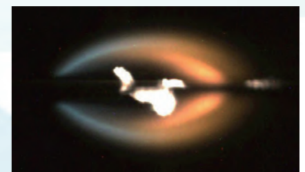
ろ紙試料上を燃え広がる火炎画像 ©弘前大学/岐阜大学/北海道大学/JAXA
