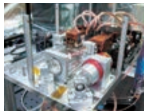
Qswパルスレーザ (与圧筐体封入前の振動試験モデル)
