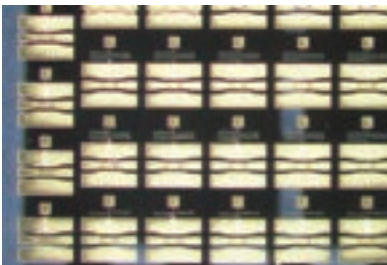
ミニマルファブで試作したRF-MEMSスイッチ群
