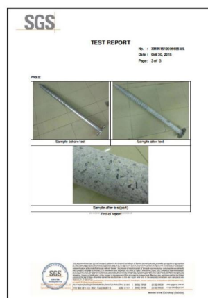
グラントスクリュー抗塩霧テスト Ground Screw Salt Spray Test SGS
