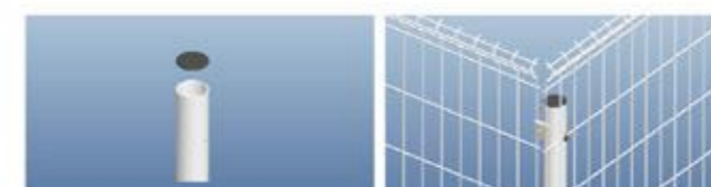
支柱キャップを支柱に取付
