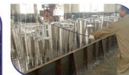
6. 溶接垂鉛メッキ
