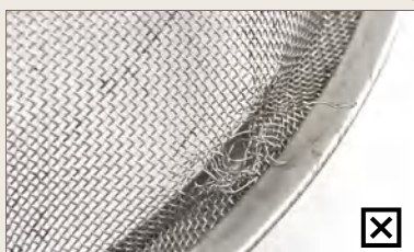
Welded Edge --Sharp Burrs
