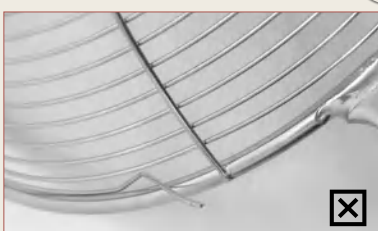
Welded Edge --Sharp Burrs
