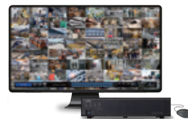
現場での監視(エッジストレージのモニター)
