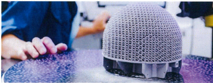
月面着陸に成功した SLIM の脚部に採用されたラティス構造の衝撃吸収材。
