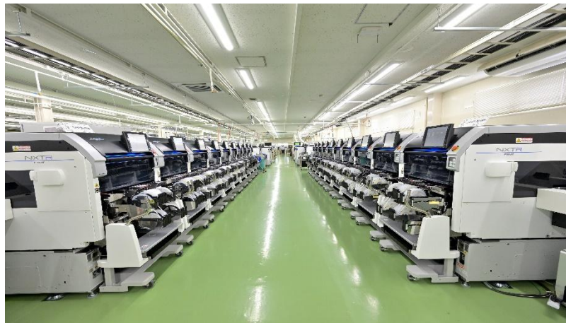
12ライン98台の実装マウンターで量産・多種少量品の基板実装
