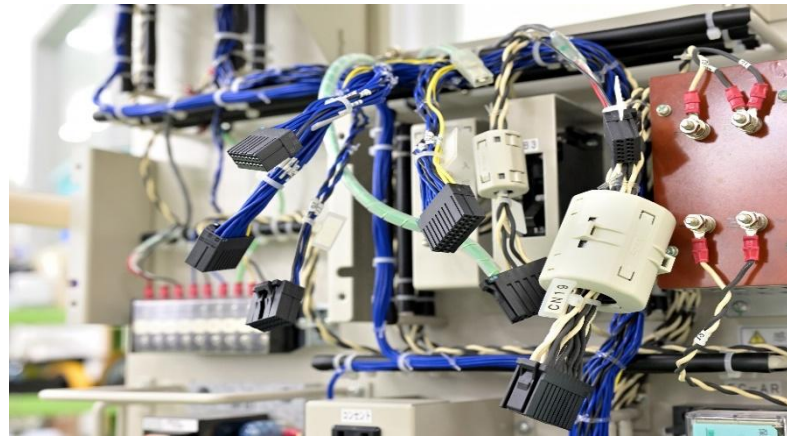
大型製品の組立配線・ハーネス加工（横120×奥60×高さ200cm等） ※装置1台あたり約2500本の配線
