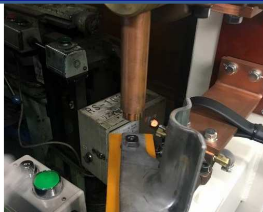
スポット溶接
