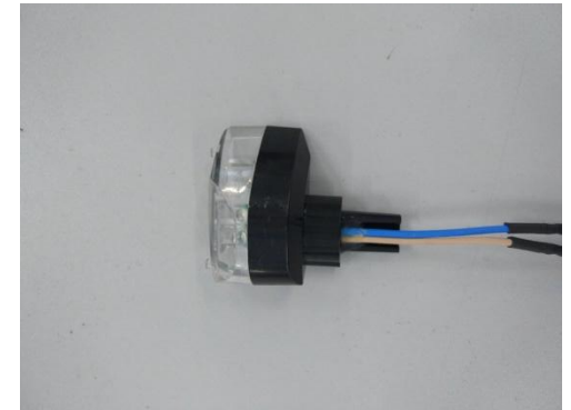
回路ケース（ポリカーボネート） 回路ケース（ポリアミド） ハーネス
