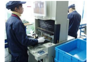
三島工場からのデータ移管が可能なICT検査機
