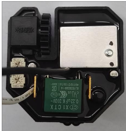
回路ケース（ポリアミド）・ハーネス・端子（黄銅） 駆動部品（ABS樹脂）・ポッティング樹脂充填
