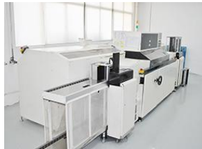
部品挿入実装を効率的に進める自動挿入機
