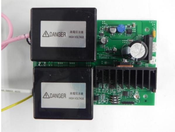
回路ケース（ポリカーボネート） ヒートシンク（アルミ）
